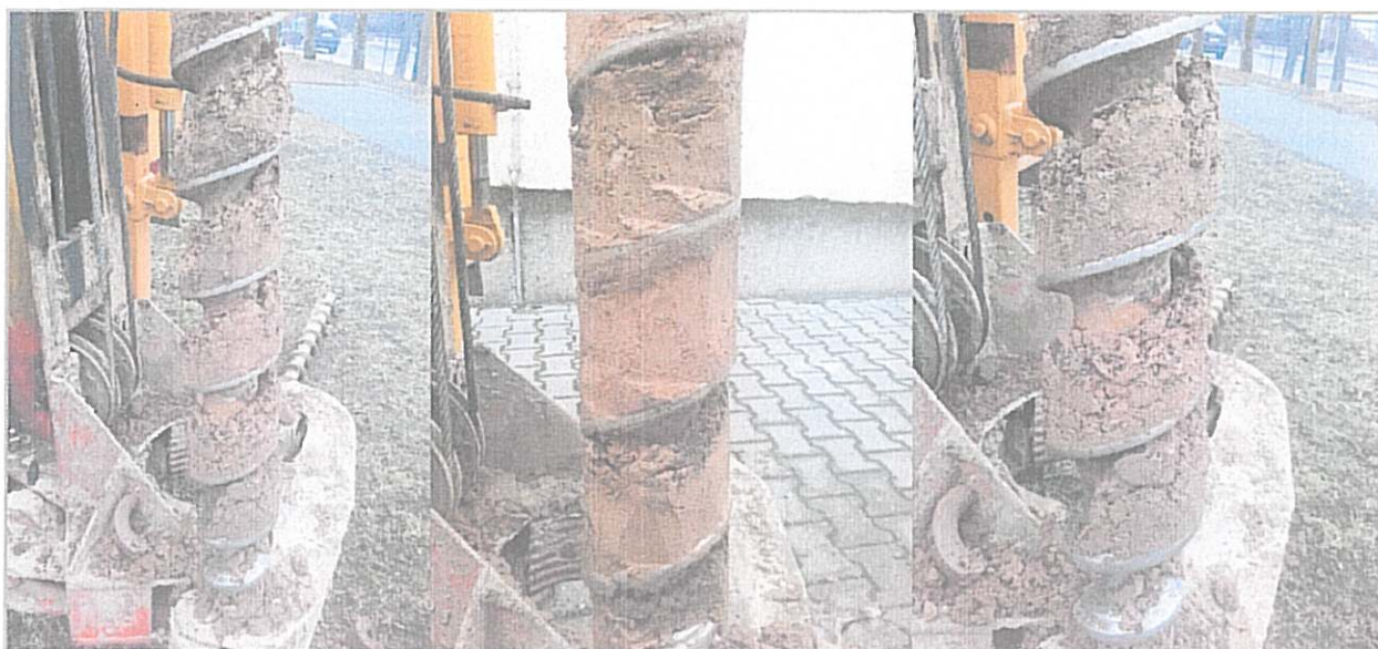
Ryc.3. Grunty spoiste podłoża budowlanego
